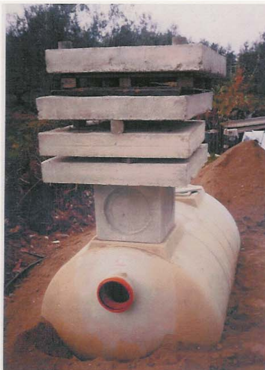
Foto 2 – Vasca per il trattamento di acque reflue in aree di servizio. Caricamento massimo (circa 44 kN) durante una prova di carico eseguita in stabilimento. Lo schema statico realizzato non prevede ripartizione del carico e, per la mancanza di contenimento laterale, realizza la massima ovalizzazione del manufatto.
