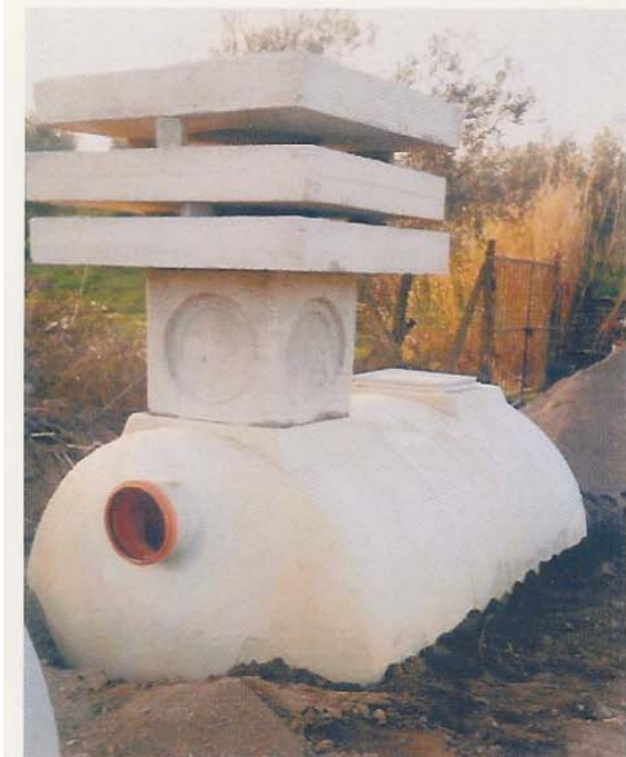
Foto 1 – Vasca per il trattamento di acque reflue in aree di servizio. Fase di caricamento durante una prova di carico eseguita in stabilimento. Lo schema statico è particolarmente gravoso in quanto manca l'azione di contenimento laterale del terreno.
